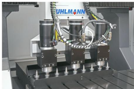
Mehrspindel-Einrichtung mit Werkzeugmagazin
