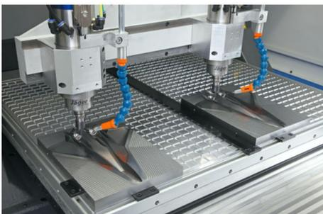
Raster-Vakuumtisch und 2-Spindel-Einrichtung
