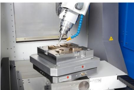
B-Achse mit Frässpindel. Rundtisch als C-Achse
