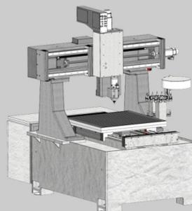
**Topas S3 mit Aluminium-Raster-Vakuumtisch und 16-fach Rundwechsler**
