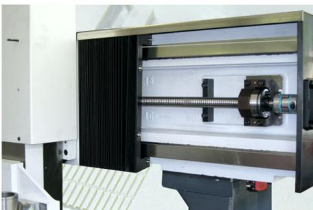
Führungssystem mit Kugelgewindtrieb
