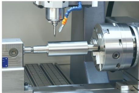
Teilkopf 4.Achse mit Aufspannschiene
