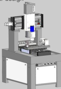
**S4 mit Teilkopf und Aufspannschiene und Werkzeugmagazin**
