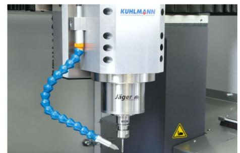
Z-Achse mit optionaler Frässpindel
