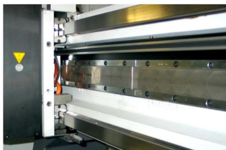
X-Achse mit Linearmotor und Diadur-Glasmaßstab
