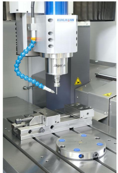
Arbeitstisch mit Mehrfach-Spannung
