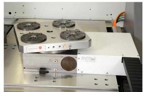
Rundtisch als C-Achse mit Paletten Spannsystem optional
